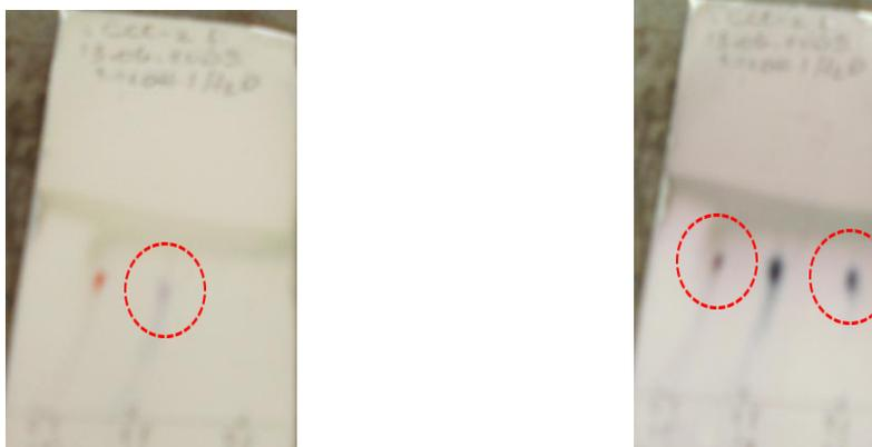
**Figura 35.** Placas de TLC  $\text{CH}_3\text{OH}/\text{H}_2\text{O}$  (8:2 v/v) correspondientes a las fracciones 2, 3 y 5 del LCNM.
