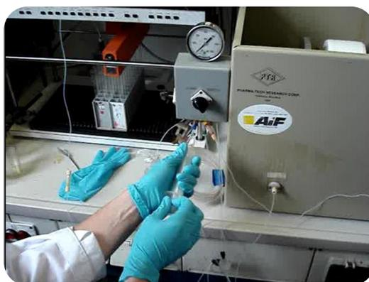
**Figura 28.** Inyección de la muestra en el HSCCC.
