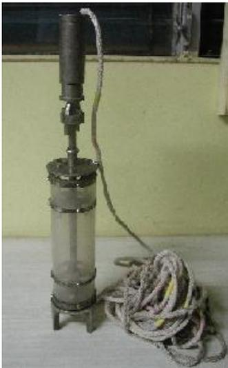
Se utilizó una Botella colectora de agua tipo Kitahara con capacidad de 1 litro (Figura 4), se tomaron muestras de agua a profundidades de; 0m (superficie), 1m, 2m, 5m y 10m (cuando así lo permitió la marea y la altura de la columna de agua)
