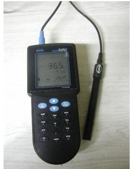
**Figura 5: Salinómetro**
