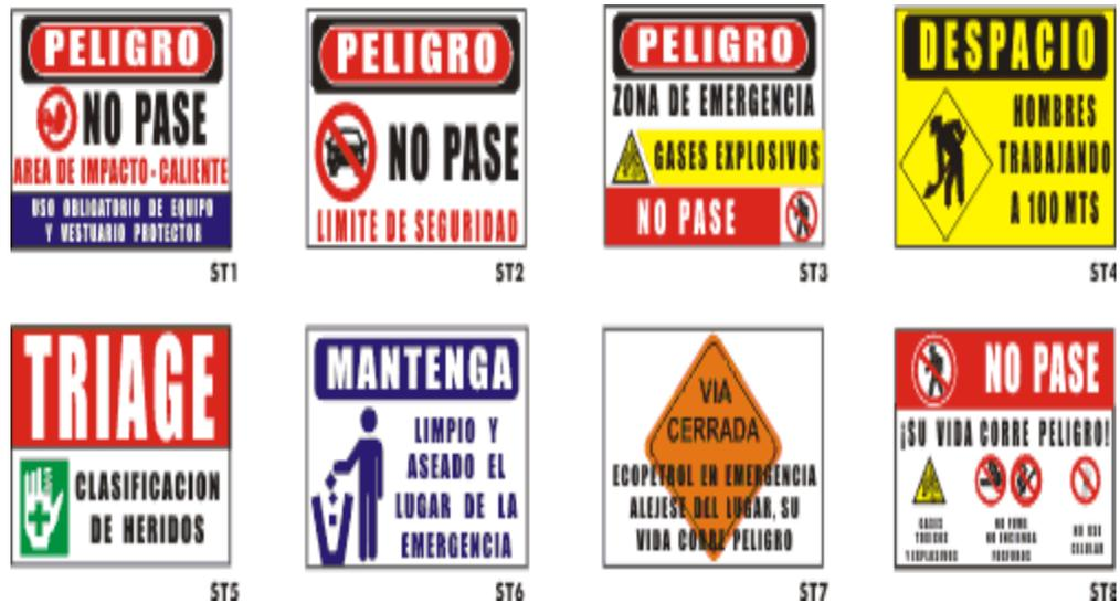
Este tipo de señales está diseñado para limitación de áreas en donde es necesario advertir a los transeúntes las condiciones con las que se pueden encontrar. Estas señales son tipo tijera, completamente portátiles, fáciles de manipular y transportar de un sitio a otro.<sup>36</sup>
