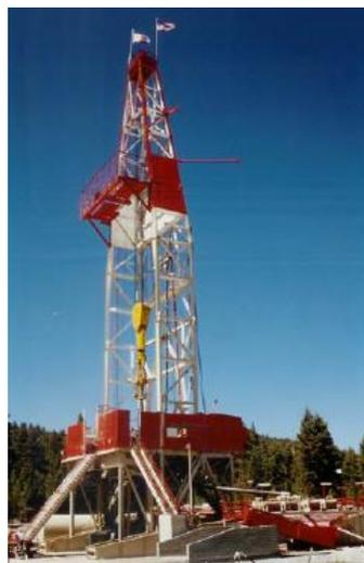
Figura 2. Torre de perforación rotatoria, mástil de
