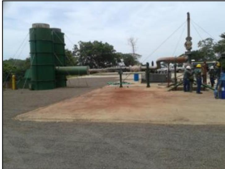
Figura 8. Silenciador portátil para descarga del pozo.
