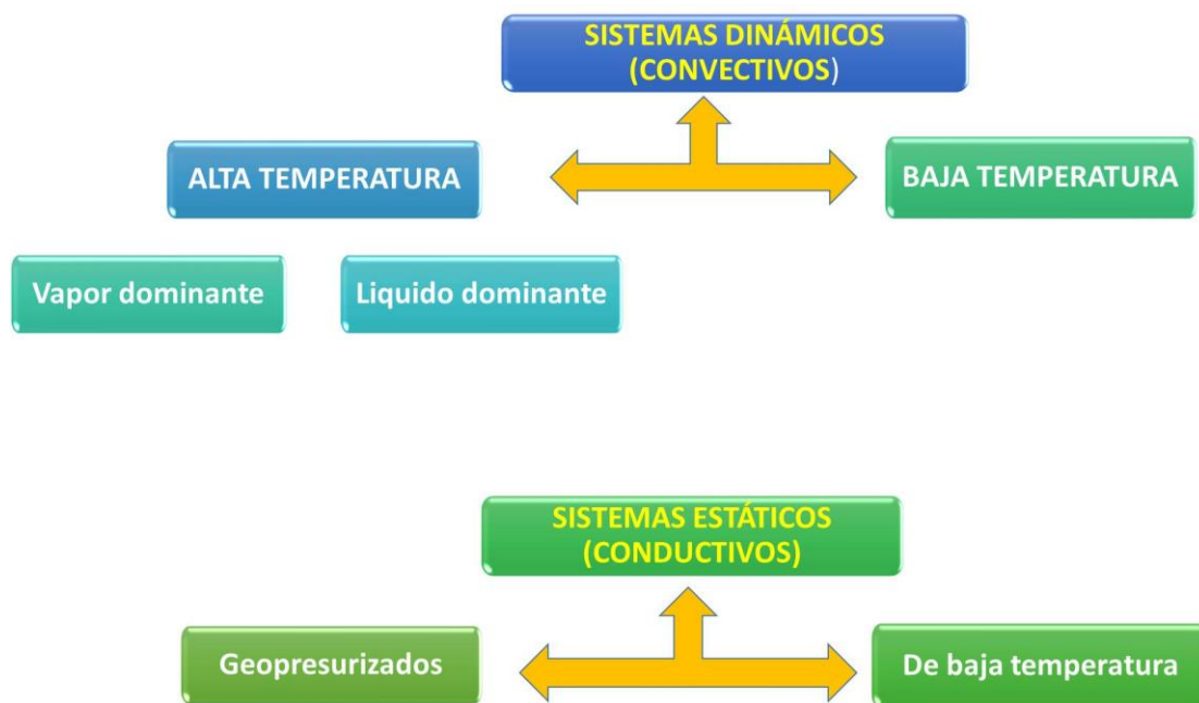
Figura 18. Esquema de clasificación de sistemas geotérmicos en base al origen de sus fluidos.
