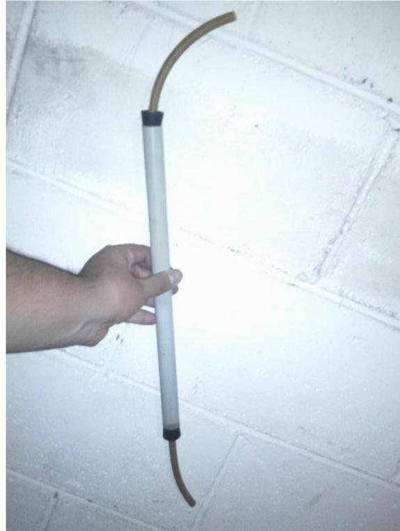
Filtro artesanal con capa de huevo molido para filtrar metales pesados, a la derecha filtro a escala basado en el mismo sistema.
