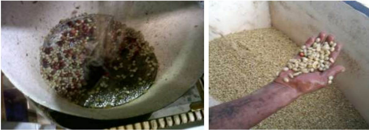
PULPEROS DESCASCARANDO EL CAFÉ UVA A TRAVÉS DE LA FRICCIÓN DE DISCOS DE METAL PARA OBTENER EL CAFÉ PERGAMINO HUMEDO.
