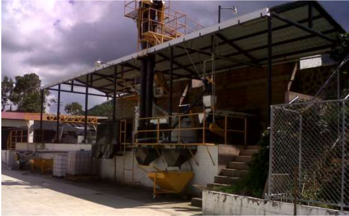
DESPULPadora de café de cilindro vertical, "BENEFICIO EL MANZANO"
