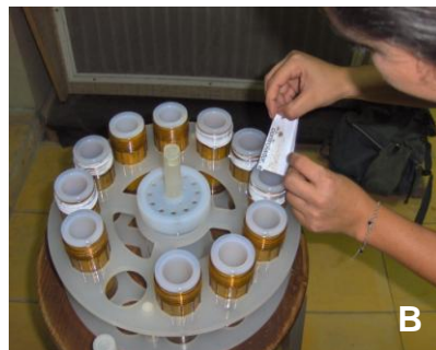
Fig. 5. A: Pesado de la muestra molida, B: Muestras en vasos de teflón para la digestión ácida.
