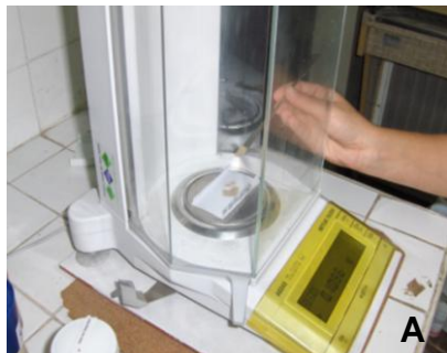
Fig. 5. A: Pesado de la muestra molida, B: Muestras en vasos de teflón para la digestión ácida.
