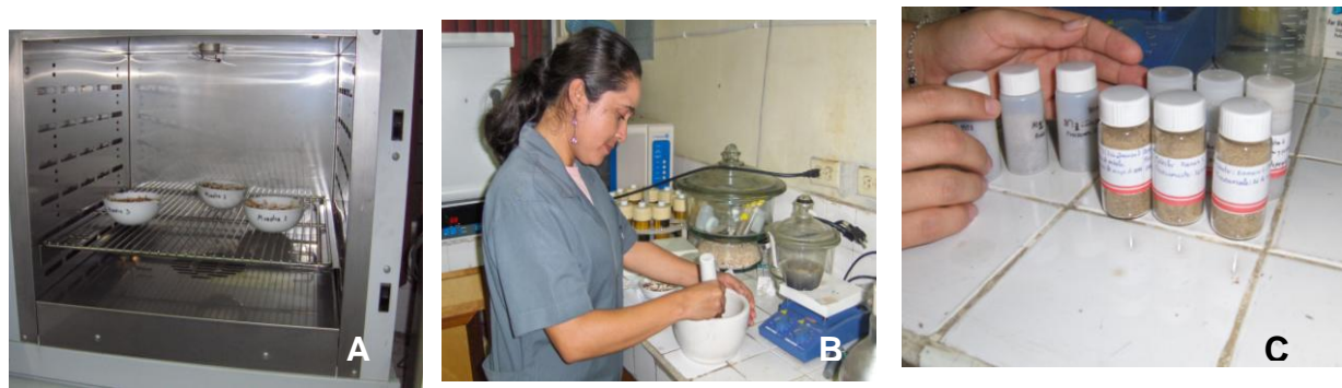
Fig. 4. A: Secado del tejido blando en estufa convencional, B: Molido de los tejidos secos, C: Muestras pulverizadas en viales de polietileno.
