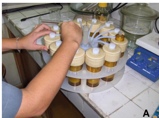
Fig. 6. A: Instalación de los tubos de teflón para sujetar muestras, B: Muestras colocadas dentro de horno microondas, para su digestión ácida.
