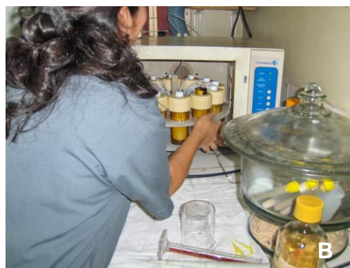
Fig. 6. A: Instalación de los tubos de teflón para sujetar muestras, B: Muestras colocadas dentro de horno microondas, para su digestión ácida.
