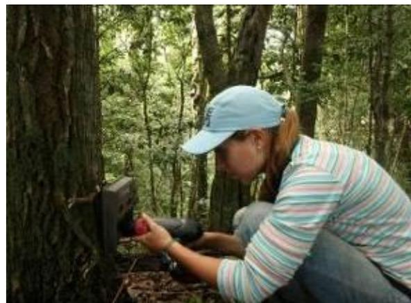
El modelo Cuddeback al igual que los otros modelos de trampa cámara se coloca en la base de los árboles pero este contiene un par de tornillos que sirven para darle mayor seguridad y menor probabilidad de robo del dispositivo.
