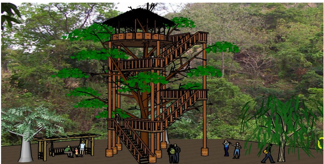
Figura 5. Mirador. Construido con madera en forma de caracol, con una altura de 10 a 15 metros, con capacidad para 10 personas
