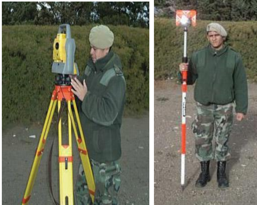
Figura 2. Estación total y Prisma (accesorio complementario) www.rs.ejercito.mil.ar/Contenido/Nro655/Revista/estaciontrimble.htm
