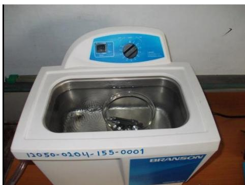
Fig. 2.13. Cámara de baño ultrasónico de la marca BRANSON modelo M3800H.
