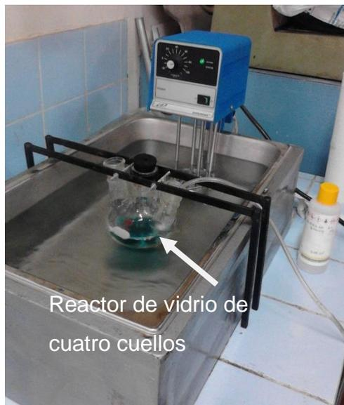
Fig. 2.10. Deposición en el reactor de vidrio.
