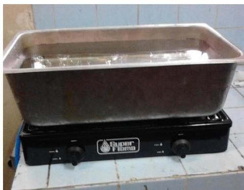
Fig. 2.14. Bandeja que contiene soda cáustica a 60 °C sobre cocina a gas de dos quemadores.
