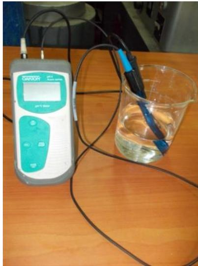
Fig. 2.9. Medidor de pH y temperatura.
