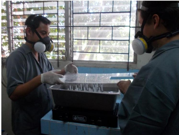
Fig. 3.10. Desengrasado de probetas en soda cáustica.
