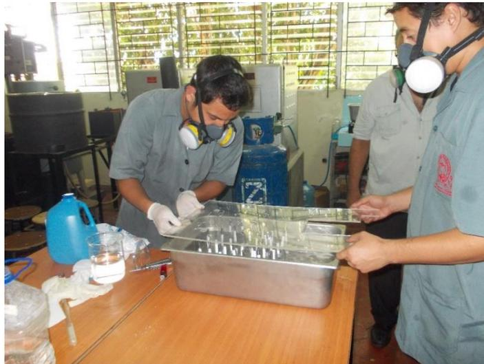
Fig. 3.12. Enjuague de probetas en agua destilada a temperatura ambiente.
