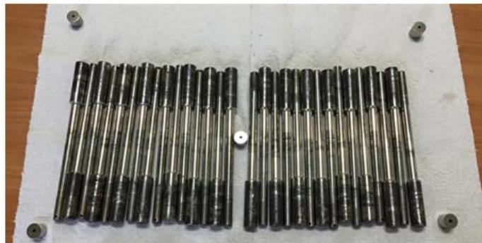
Fig. 3.19. Probetas de fatiga recubiertas y con PTT-1.
