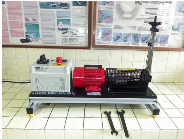
Fig. 2.16. Máquina para ensayos de fatiga por flexión rotativa marca GUNT modelo WP 140.
