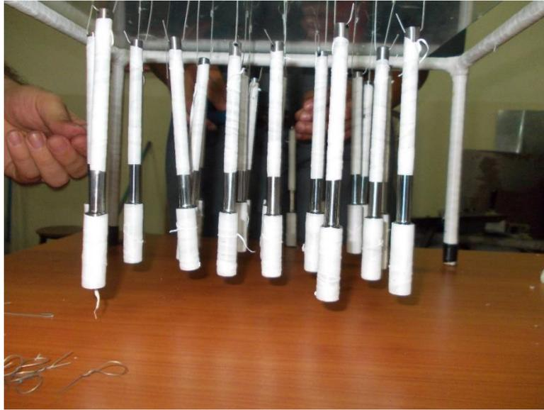
Fig. 3.9. Probetas limpias suspendidas en la tapa de acrílico del sistema de deposición autocatalítica.
