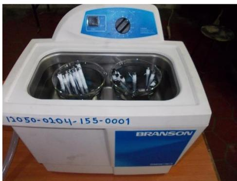
Fig. 3.8. Lote de 30 probetas durante el desengrasado en acetona en cámara de ultrasonido.
