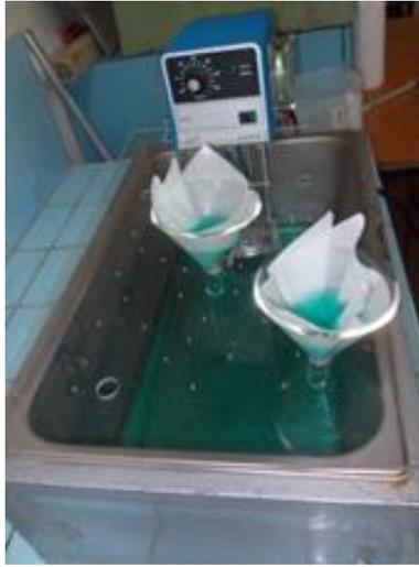
Fig. 3.3. Representación del segundo filtrado de la solución.
