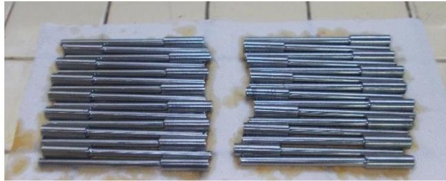
Fig. 3.5. Probetas puestas en papel toalla para absorber el exceso de aceite para iniciar el desengrasado.
