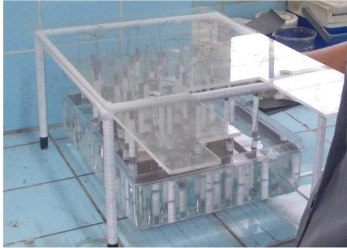
Fig. 3.11. Activación de superficie en ácido clorhídrico (HCL) al 20% durante 1 min.
