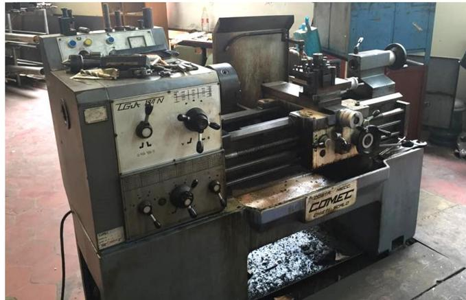
Fig. 2.3. Torno convencional marca COMEC, modelo TGA 180 N.
