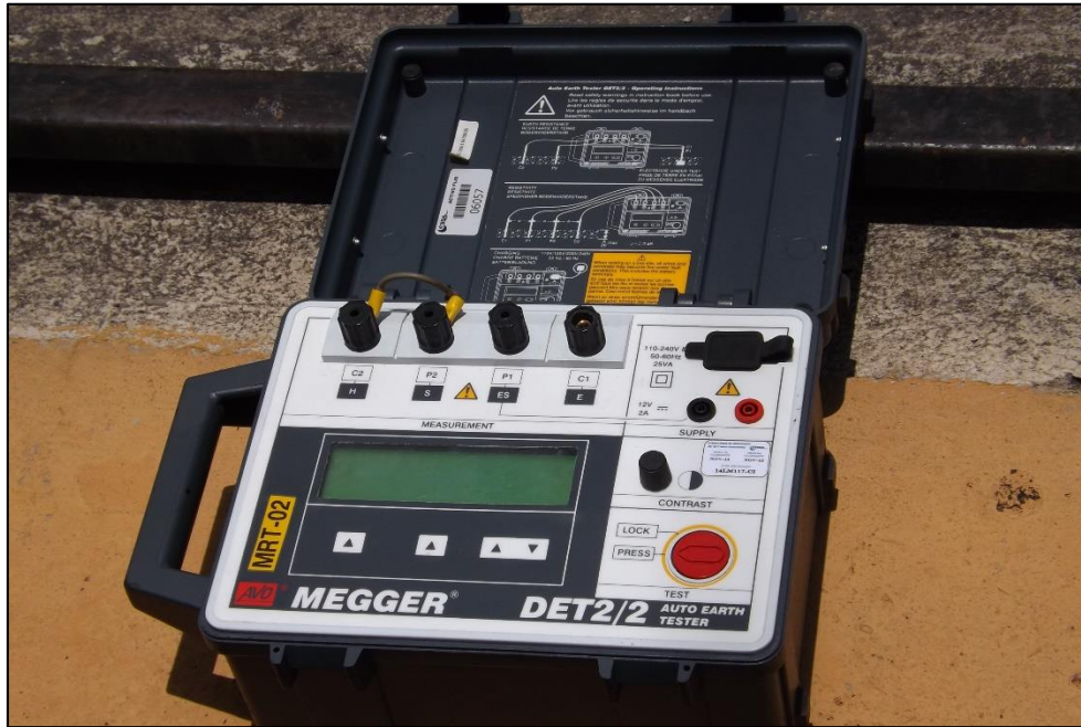
Figura J.9: Puente entre terminal C1 y P1 en telurometro
