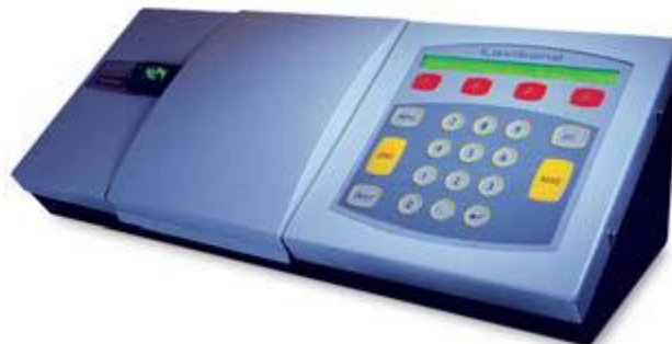
Figura 3.6: equipo comparador de color de tipo electrónico.
