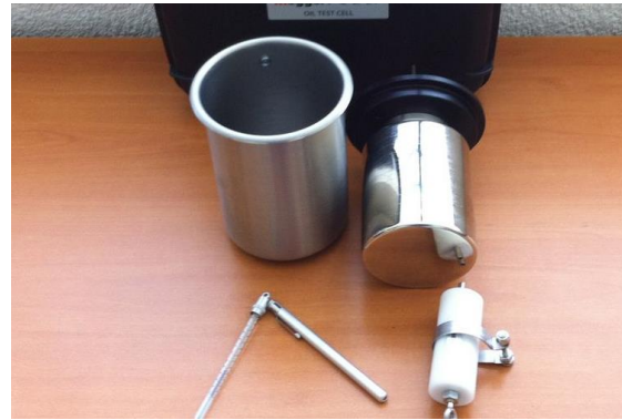
b) Celda para prueba de factor de potencia para aceites dialecticos
