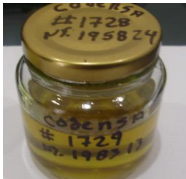
Figura A1.5: rotulación de la muestra de aceite
