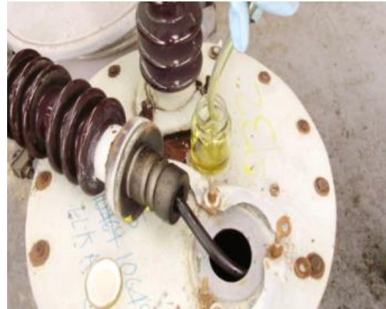
Figura A1.4: llenado de la muestra
