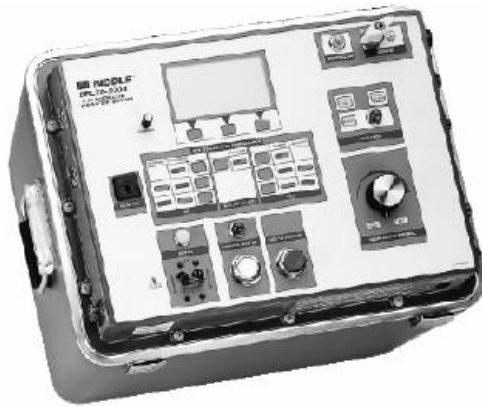
a) Medidor de factor de potencia de aislamiento
