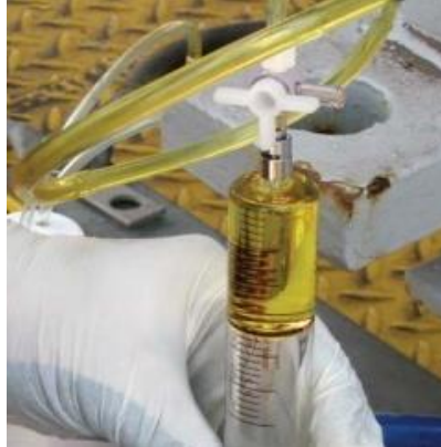
Figura A1.11: forma de evacuar burbujas y aire de la jeringa
