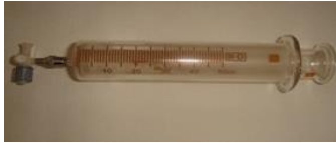
Figura A1.6: jeringa de vidrio de 50ml con válvula de tres vías incorporada.
