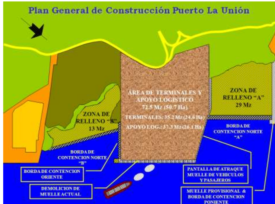
Figura 4 Plan de construcción del Puerto.
