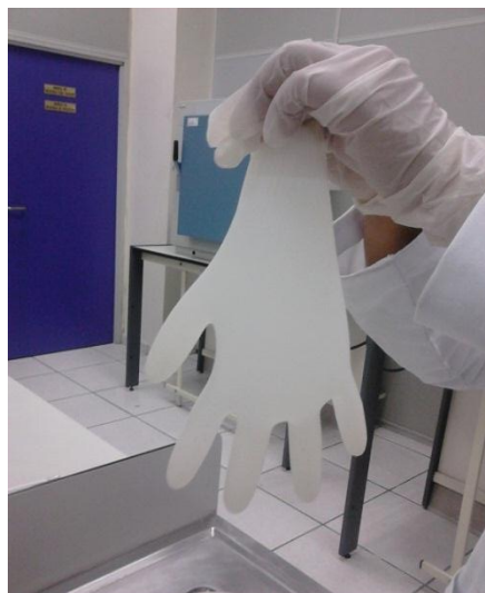
Figura N°24. Prueba de Integridad. Los guantes no presentan fugas ni orificios
