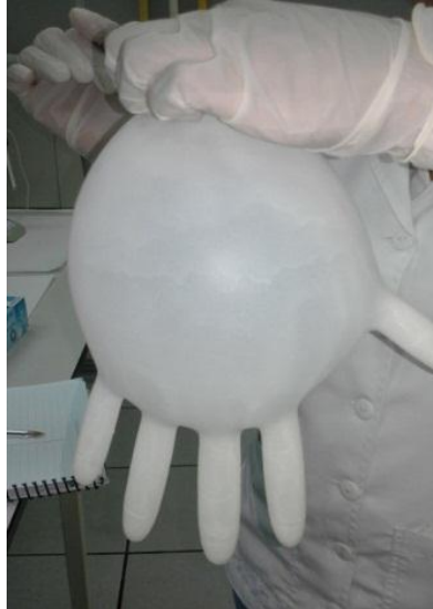
Figura N°23. Prueba de verificación del acabado
