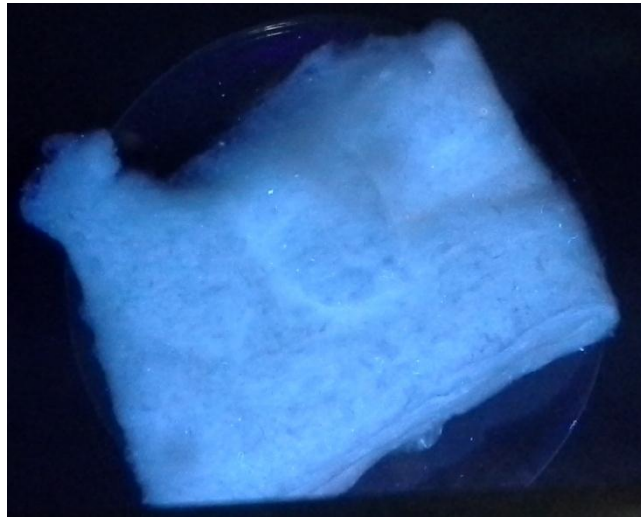
Figura N°37. Resultado negativo para muestra de algodón: Sin blanqueadores ópticos
