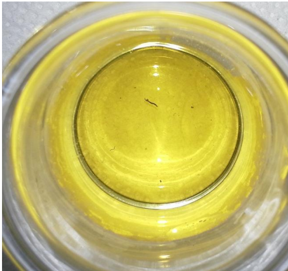
Figura Nº 36. Resultado positivo: Contiene residuo fibroso
