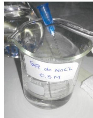
Figura N°22. Prueba de Resistencia a la Corrosión
