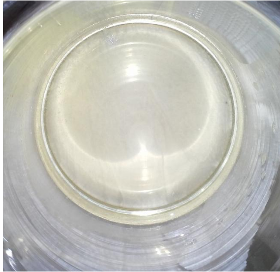
Figura Nº35. Resultado negativo: Sin residuo fibroso. Gasa 100% de Algodón.
