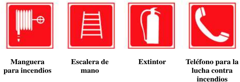
Figura. 4. Señales relativas a los equipos de lucha contra incendios.
