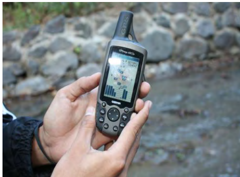
Figura 3. Equipo GPS utilizado para georeferenciar los puntos de muestreo.
