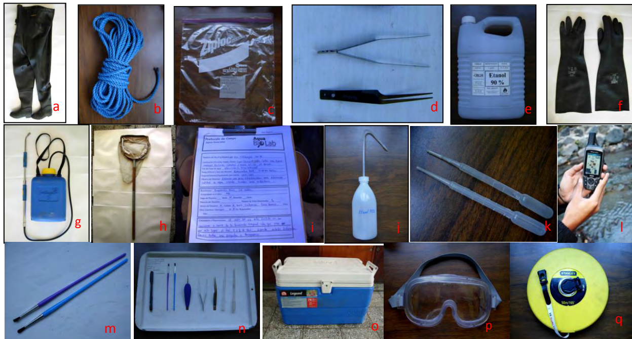
Fig. 1. Diferentes materiales y equipos a preparar previo a la salida al campo para muestrear con red "D": a. Traje de vadeo, b. Lazo plástico, c. Bolsa plástica, d. Pinzas, e. Garrafa con alcohol, f. Guantes de hule, g. Bomba de asperjadora, h. Red "D", i. Formulario para anotar la información, j. Pizeta, k. Goteros, l. GPS, m. Pinceles, n. Bandeja, o. Hielera, p. Lentes, q. Cinta métrica
