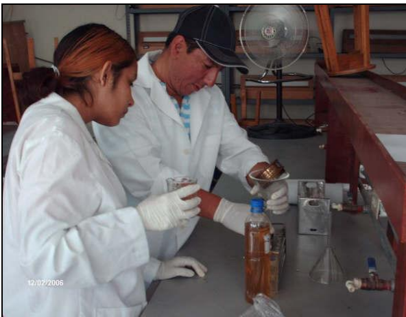
Figura 10: A) Colado de la muestra y colocación en tubos de ensayo. B) Toma de muestra para análisis en microscopio.
