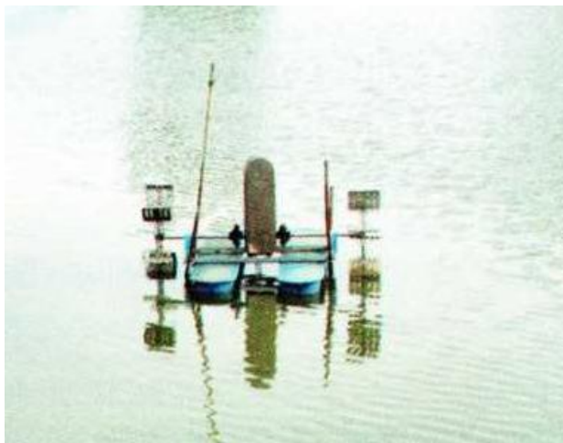
Imagen No. 16 - Aireador utilizado para oxigenar el agua
