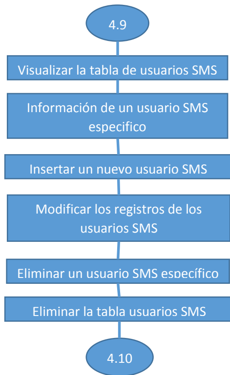
Figura 2.48: Diagrama de flujo del funcionamiento del proceso de usuarios SMS.
