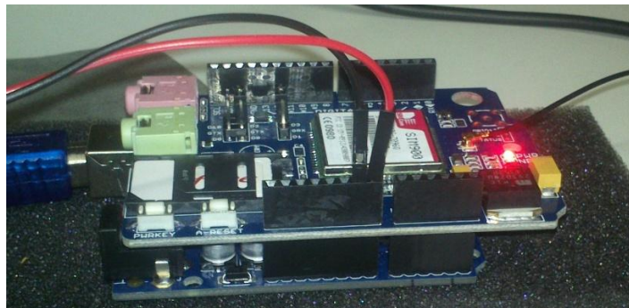
Figura A.3: Conexión entre el arduino UNO y el arduino shield SIM 900 (GPRS Shield V1.1(B)).
