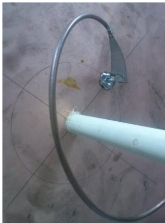
Figura 2.22: Adaptador de impedancia de antena helicoidal.
