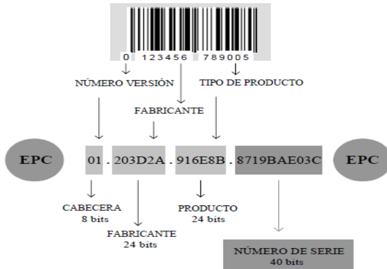
Figura 1.22: Detalle del EPC en su versión de 96 bits 28 .
