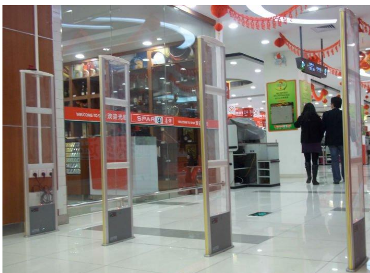
Figura 1.26: Torres de antenas antirrobo para centros comerciales que utilizan tecnología RFID.
