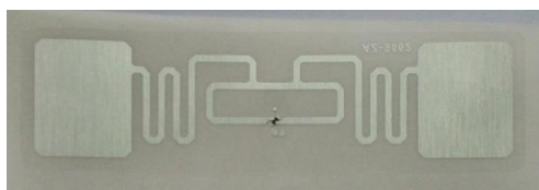
Figura 2.6: Etiqueta UHF RFID adhesiva, pasiva.
