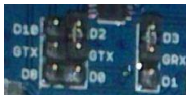
Figura A.4: Puentes en el shield SIM 900 para elegir los pines de comunicación TX y RX.
