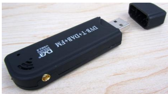
Figura 2.27: Sintonizador de RF utilizado como analizador de espectro.
