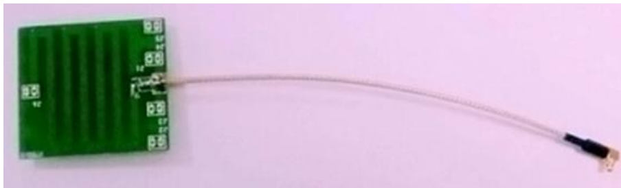
Figura 2.5: Antena de 5dBi PCB UHF RFID 902 - 928 MHz, 5 cm X 5 cm.
