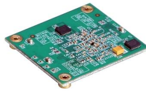
Figura 10. Cancelador de eco hardware EC32L de ATCOM.
