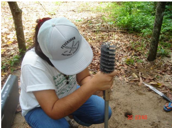
3. cepillo para limpiar las paredes del agujero.
