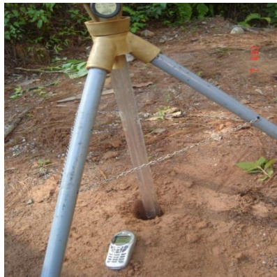
7. Medición del tiempo de infiltración.
