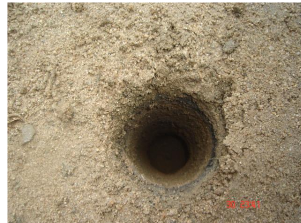
4. Agujero de infiltración
