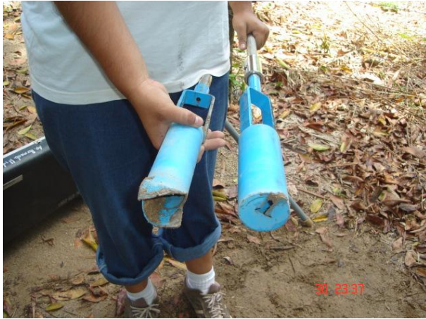
1. barreno y nivelador (equipo)
