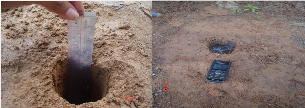
Fig.12: Pruebas de infiltración por el método de Porchet
