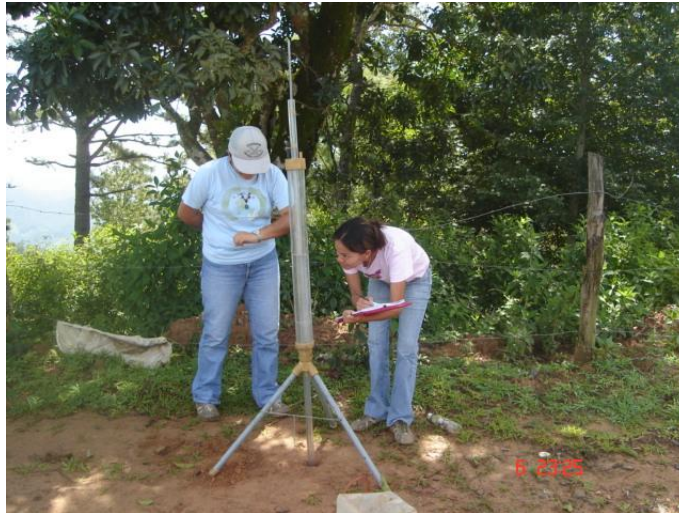
Fig.13: Determinación de la conductividad hidráulica por el método del permeámetro de Guelph.
