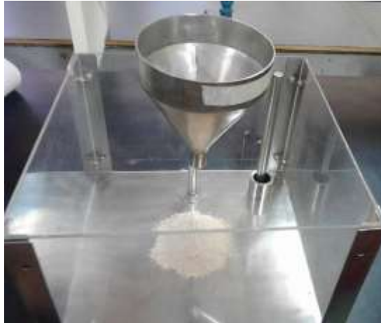
Figura 1. Equipo usado para la medición del ángulo de reposo Fuete: Elaboración propia
