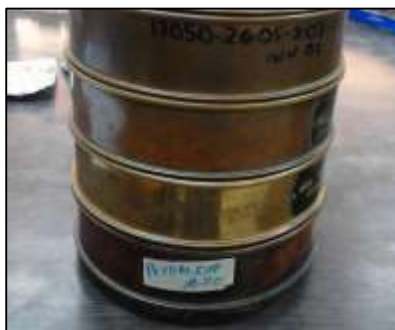
Figura 5.6. Tamices malla 60,100 y 200 usados para el análisis de cohesión
