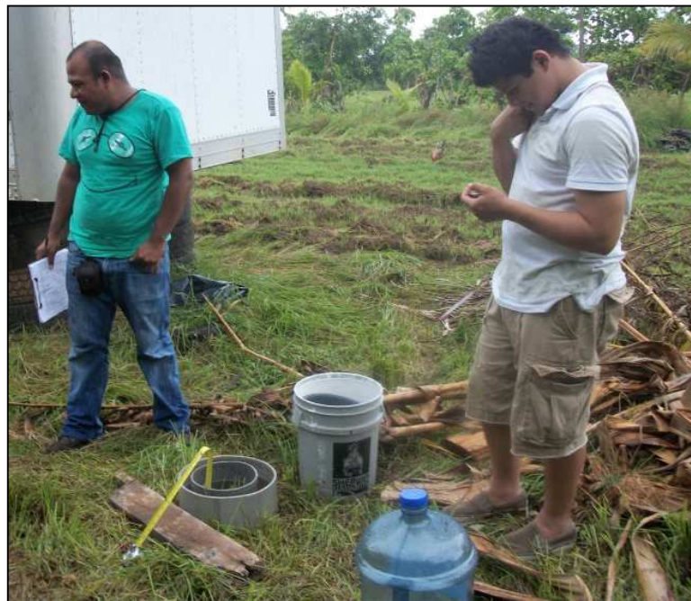
Figura 3.8. Prueba de infiltración, mediante el empleo del método Doble Anillo. Caserío El Chino. Fecha: 15 de junio de 2013.
