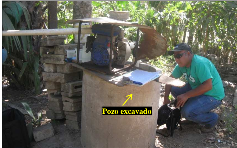
Figura 3.3. Pozo excavado identificado como CSE15, propiedad de Francisca Perdomo, caserío El Chino. Medición del nivel estático, mediante el empleo de sonda para medición de niveles Fecha: 02 de febrero de 2013.
