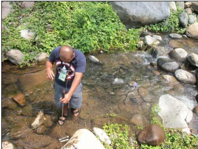
Figura 3.9. Aforo mediante el empleo de molinete propiedad del MARN. Río San Francisco.
