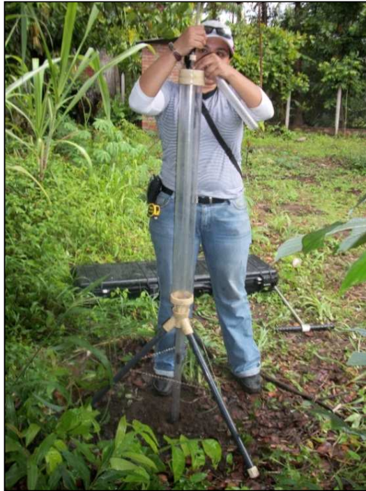
Figura 3.7. Prueba de infiltración en caserío El Chino, mediante el empleo de un infiltrómetro Guelph, propiedad de la UES. Fecha: 15 de junio de 2013.
