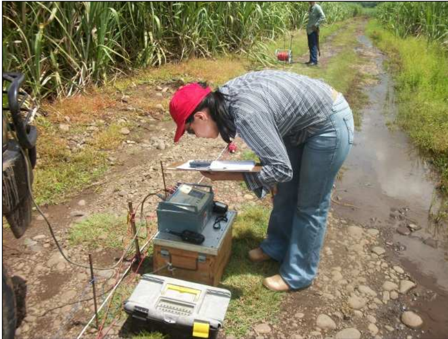
Figura 3.6. Resistivimetro empleado en el desarrollo de SEV. Equipo propiedad de la Administración Nacional de Acueductos y Alcantarillado (ANDA).
