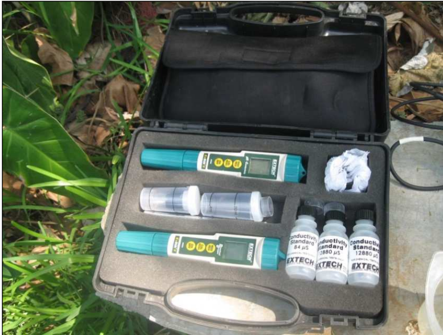
Figura 3.5. Equipo multiparámetro empleado para la medición en pozos. Equipo propiedad de la Dirección General del Observatorio Ambiental del MARN.
