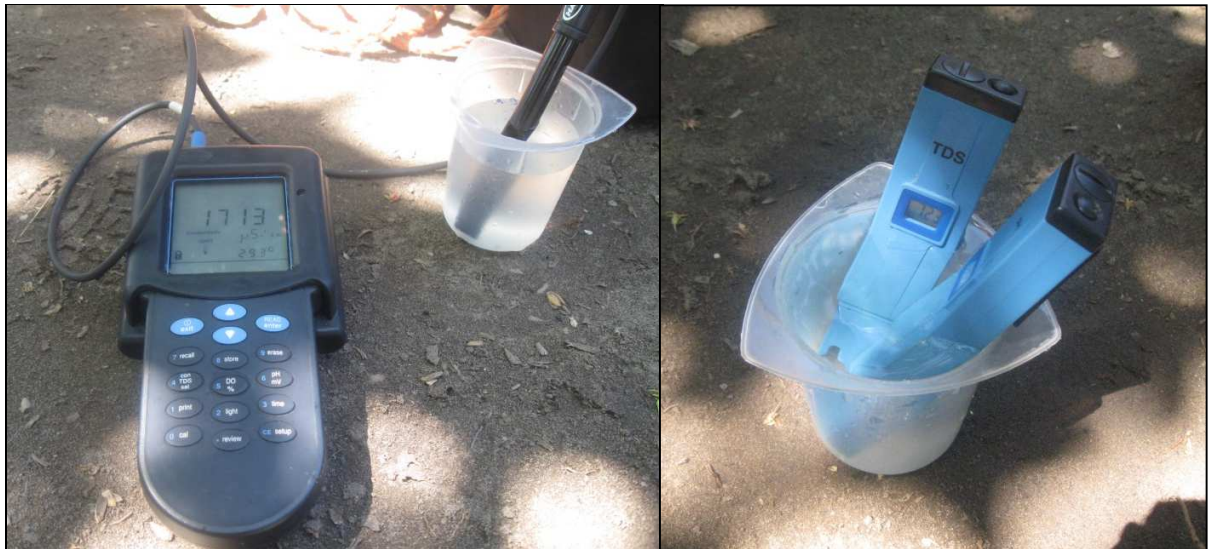
Figura 3.4. En la fotografía de la izquierda, se observa equipo multiparámetro empleado para la medición. En la fotografía de la derecha, se observan los equipos uniparámetros empleados para la medición de Ph y TDS.
