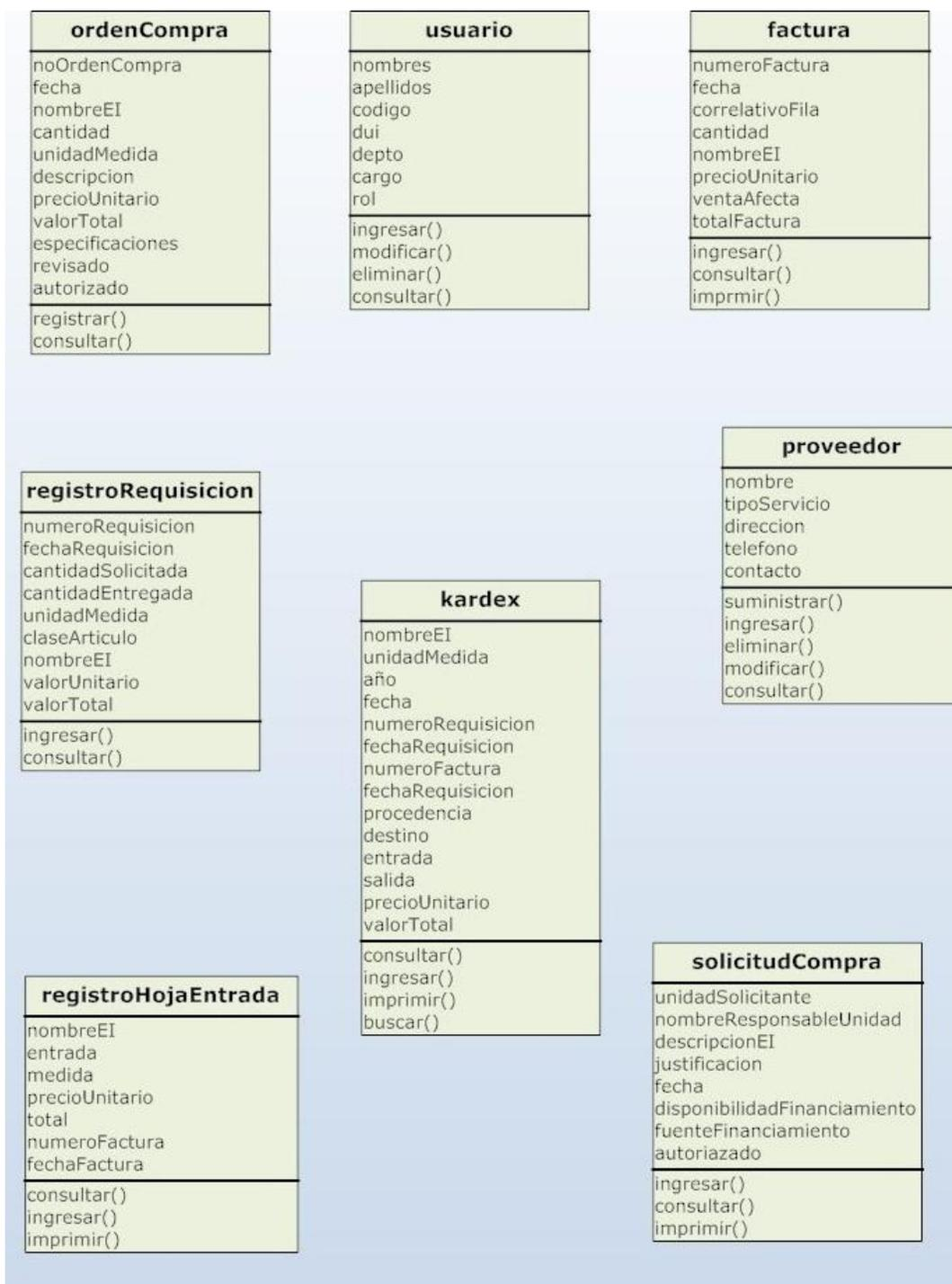
Figura 25. Diagrama de Clases Aplicación Web de la URI (Parte 2).<sup>102</sup>
