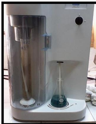
Figura 28. Tubo con muestra de pasto marino en equipo de destilación.
