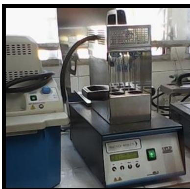
Figura 27. Tubos con muestra de pasto marino en aparato de digestión de Kjeldhal.
