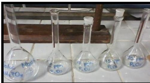
Figura 35. Balones volumétricos para solución madre y soluciones estándar calcio y magnesio.
