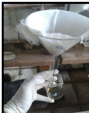
Figura 31. Filtrado de solución y recuperación en un beacker limpio.
