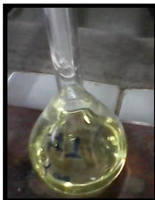
Figura 23. Solución de cenizas de pasto marino aforada a 100 ml.
