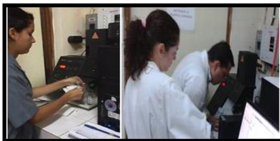
Figura 39. Lectura de contenido de Fósforo en espectrofotómetro de absorbancia.
