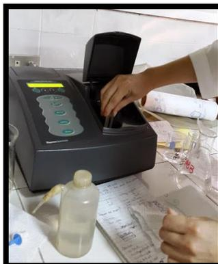
Figura 40. Lectura de resultado de Potasio en espectrofotómetro de absorbancia.
