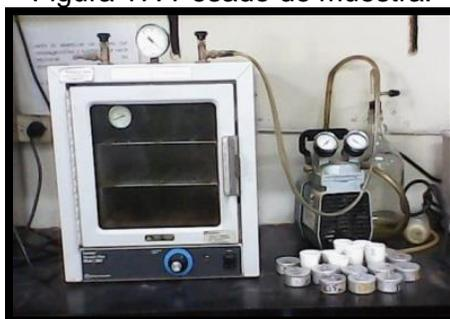
Figura 18. Estufa de vacío para extracción de humedad total.
