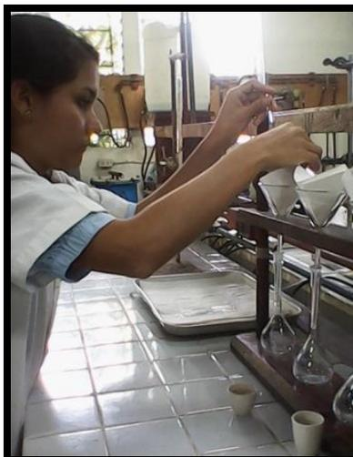
Figura 22. Filtrado de solución de cenizas de pasto marino.
