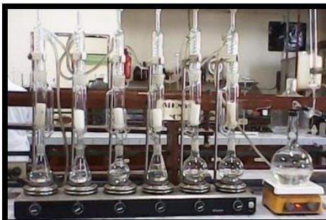
Figura 25. Dedales con papel filtro en aparato de Soxhlet.
