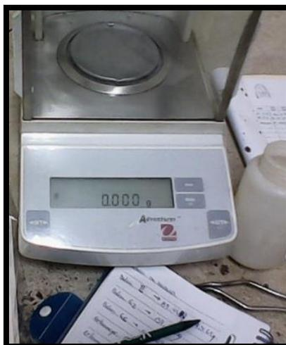
Figura 15. Uso de balanza analítica para toma de peso de muestra.
