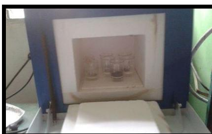
Figura 34 Muestra calcinada en crisol de Gooch.
