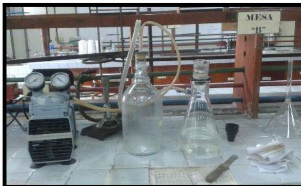
Figura 32. Filtrado de solución del crisol de Gooch.
