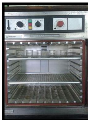
Figura 33. Secado de crisol de Gooch en estufa.
