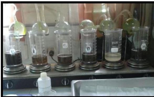
Figura 30. Beacker de 600 ml con solución de muestra y ácido sulfúrico.
