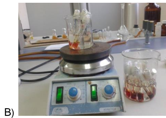
A) y B) Figura N° 22: Análisis de Azúcares totales por DNS
