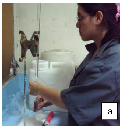
Figura 6. Medición de acidez (a) Medición de acidez. (b) Materiales para realizar la prueba.
