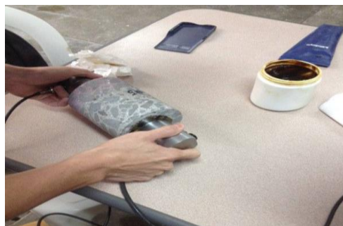
Figura 4.11: Prueba de pulso ultrasónico a núcleo extraído de la vía en estudio.
