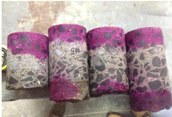
Figura 5.2: Núcleos de concreto rociados con fenolftaleína (prueba de carbonatación).
