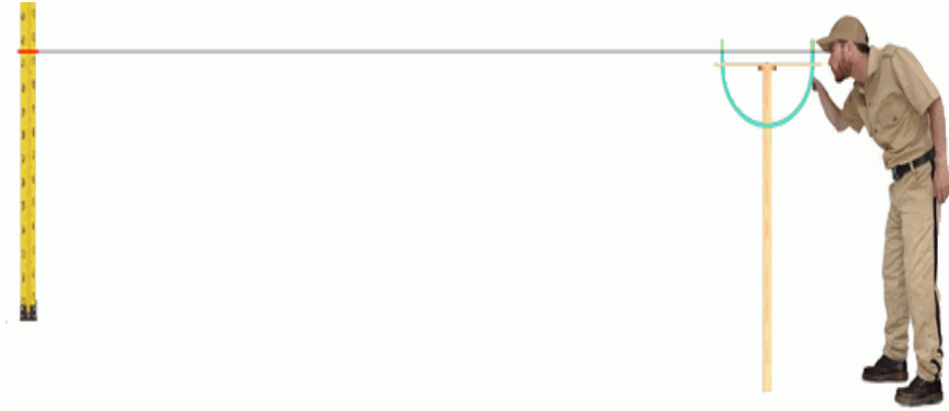
Figura 3.13: Levantamiento con mira y nivel ( http://galeon.com , consulta: 04/05/2015 ).
