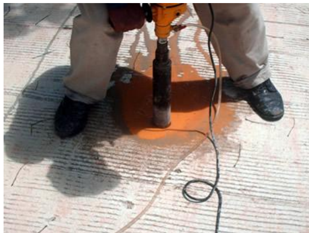
Figura 3.18: Extracción de núcleos de concreto ( http://www.dysconcsa.com , consulta: 09/05/2015).
