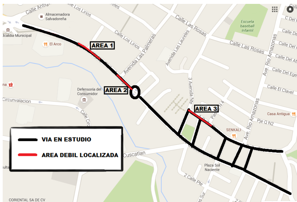
Figura 5.7: Áreas débiles localizadas en la vía en estudio.
