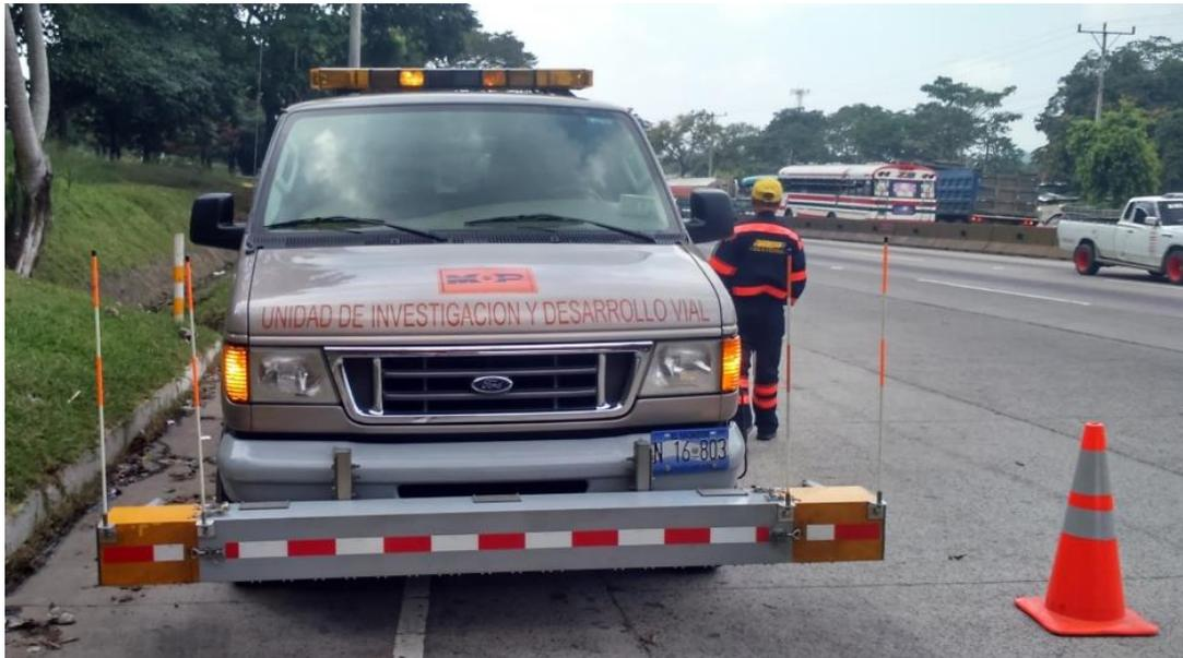
Mediciones con el Perfilómetro Láser
