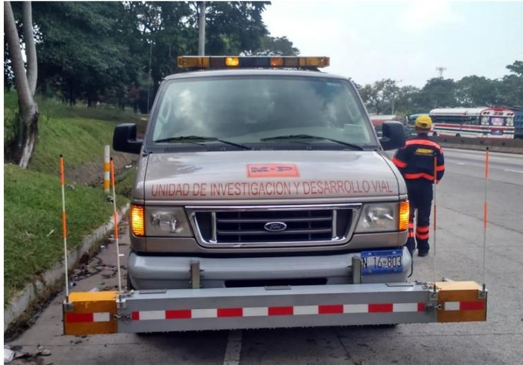
**Ilustración 3.17 Perfilómetro Láser (RSP)**
