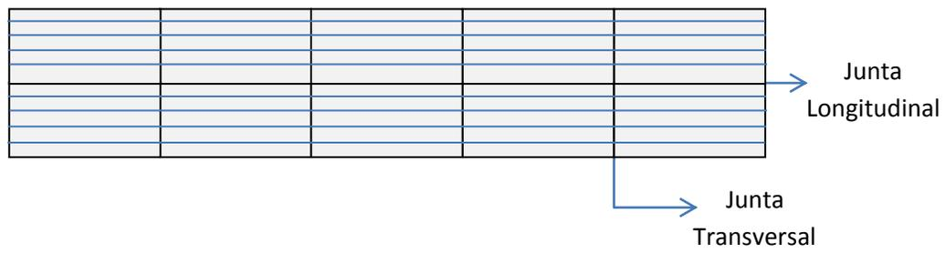
Ilustración 1.6 Pavimento con refuerzo continuo
