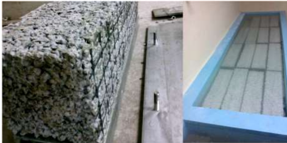
FIGURA 3. 8 Desmoldado y Curado de especímenes
