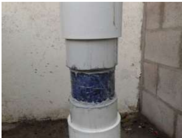
ESPECIMEN DE NUCLEO EXTRAIDO DE CONCRETO PERMEABLE.
