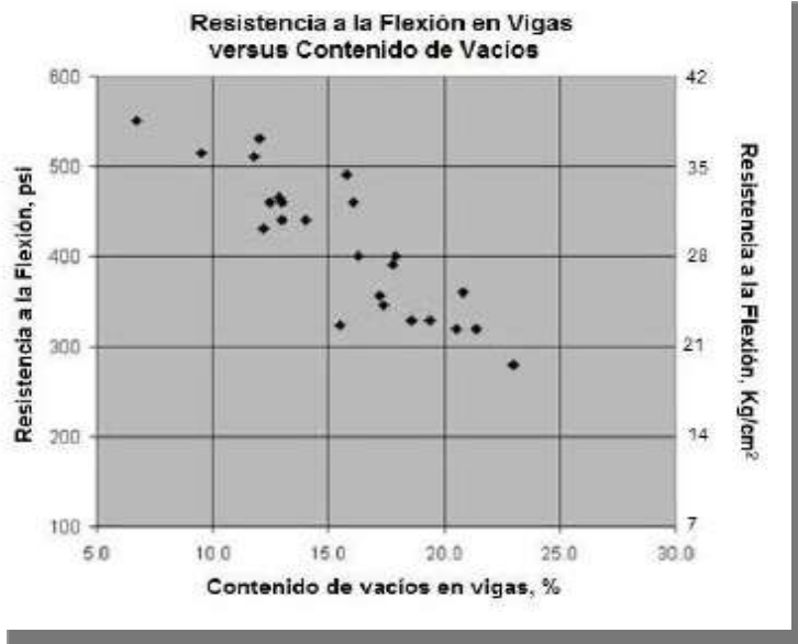
GRAFICA 2. 6 Resistencia a la Flexión en vigas versus Contenido de Vacíos FUENTE: ACI 522-10.
