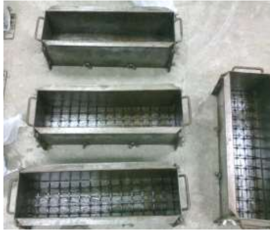
FIGURA 3. 7 Colocación de Geomalla en la base del molde de vigueta
