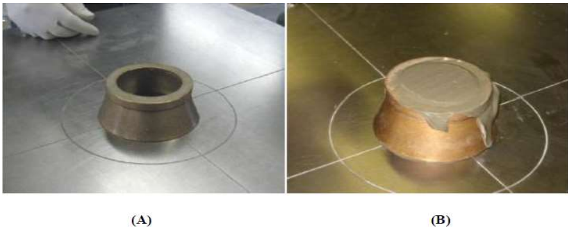
FIGURA 2. 3 Molde del cono de flujo, (A) Mesa de flujo y cono de flujo, (B) Ensayo de cono de flujo para la pasta a utilizarse en la mezcla de concreto permeable. Fuente: Pervious Concrete: Experimental Validation of Mixture Proportioning Methodology, NRMCA, 2009
