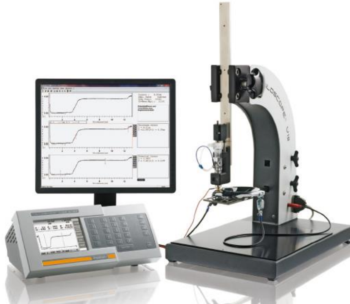
Fig. 3.3. Equipo de medición de espesores y potencial electroquímico de recubrimientos (couloscopio).
