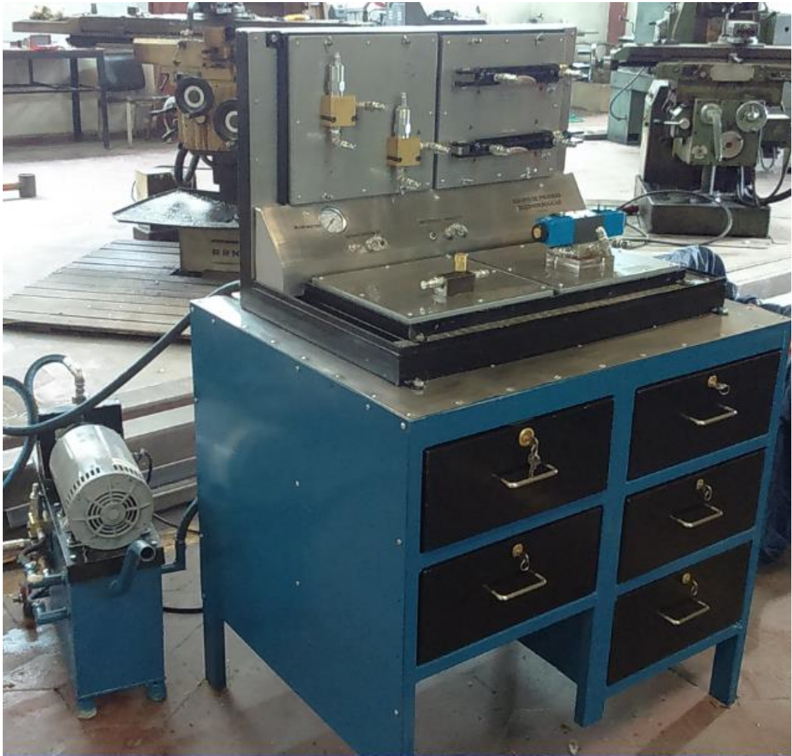
Fig. 72 Equipo para realizar prácticas oleohidráulicas.
