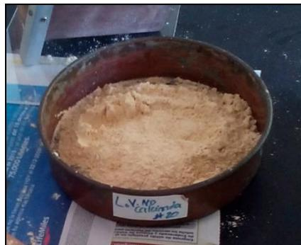
**Figura 3.5** Harina pesada y tamizada para determinar grado de cohesión.
