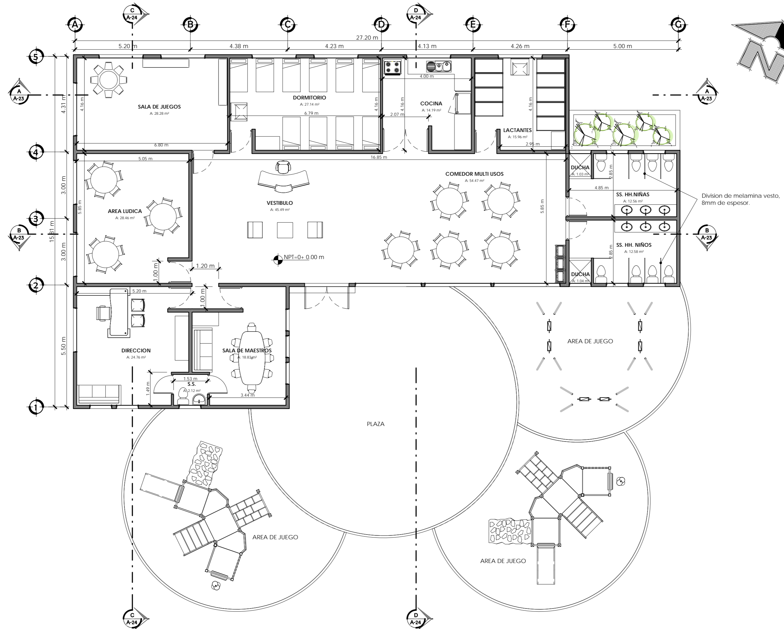
PLANTA ARQUITECTONICA - GUARDERIA Esc.: 1 : 100
