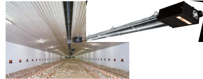
Imagen N° 36 Valores de conexión: 230 V, 50 Hz; Presión de conexión: 20mbar para gas natural y 50 mbar para gas propano.
