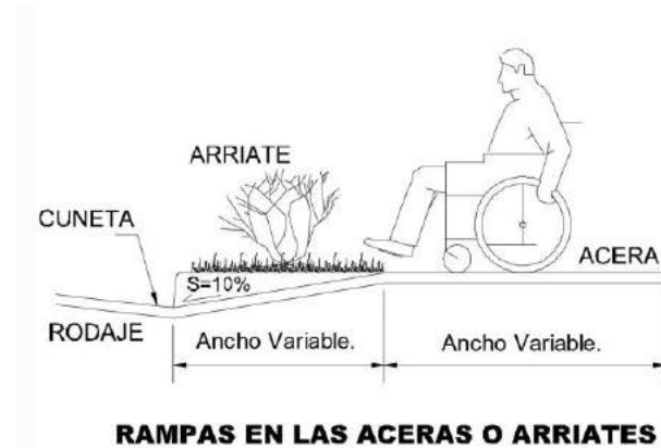
IMAGEN 25: Detalle de rampa en las aceras y arriate
