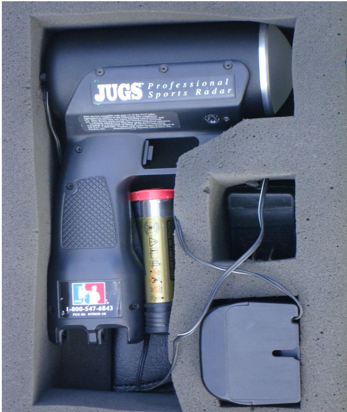
Figura 37. Radar para medir la velocidad del balón. JUGS SPEED CORDLESS MPH RADAR GUN.
