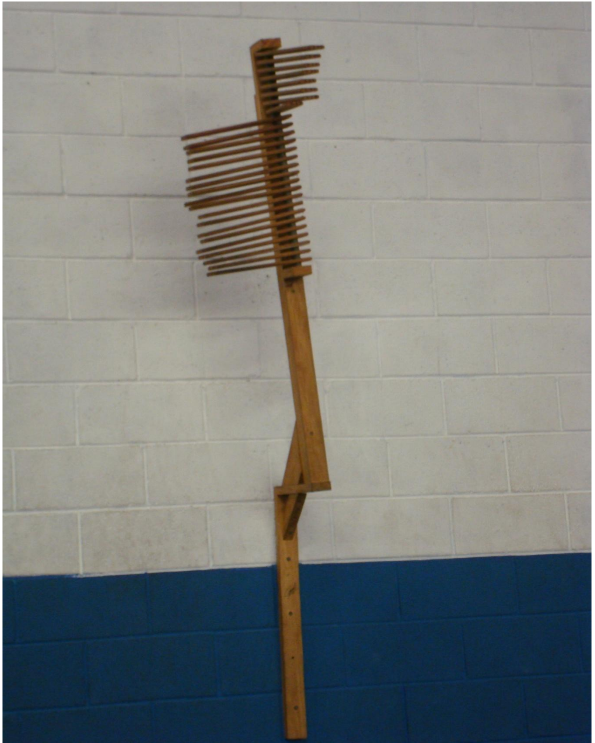
Figura 38. Estructura para la medición del salto (previamente escala).
