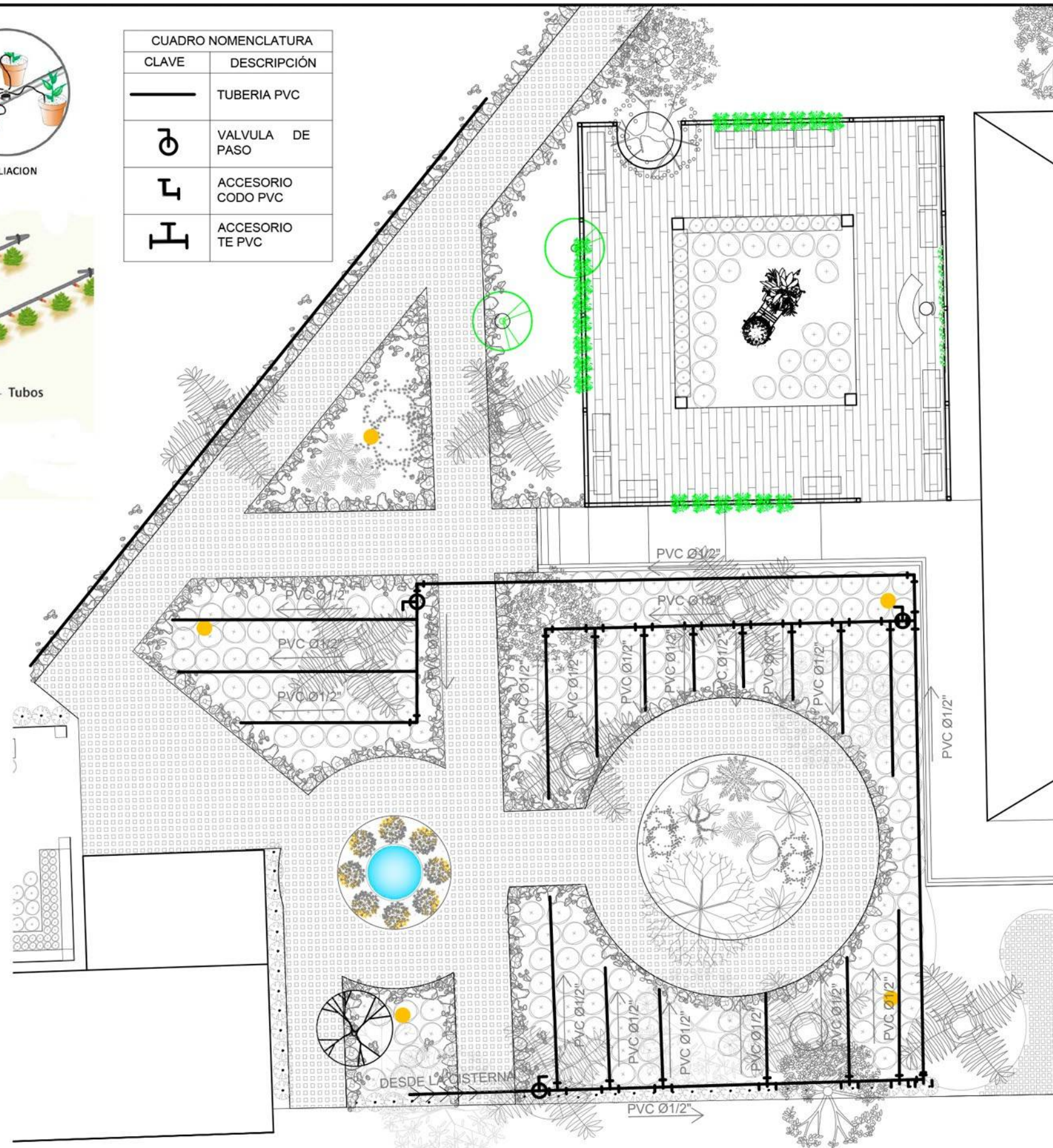
PLANTA HIDRAULICA DE RIEGO POR GOTEO
