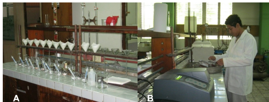
Figura A 2 Determinación de nitrógeno ureico en leche A- Filtrado de muestra, B- Lectura de muestras en espectrofotómetro
