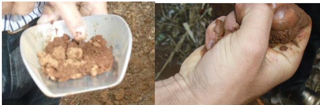
Figura No 4.2: Proceso de humedecimiento y remoldeo para evaluar dilatancia y plasticidad.
