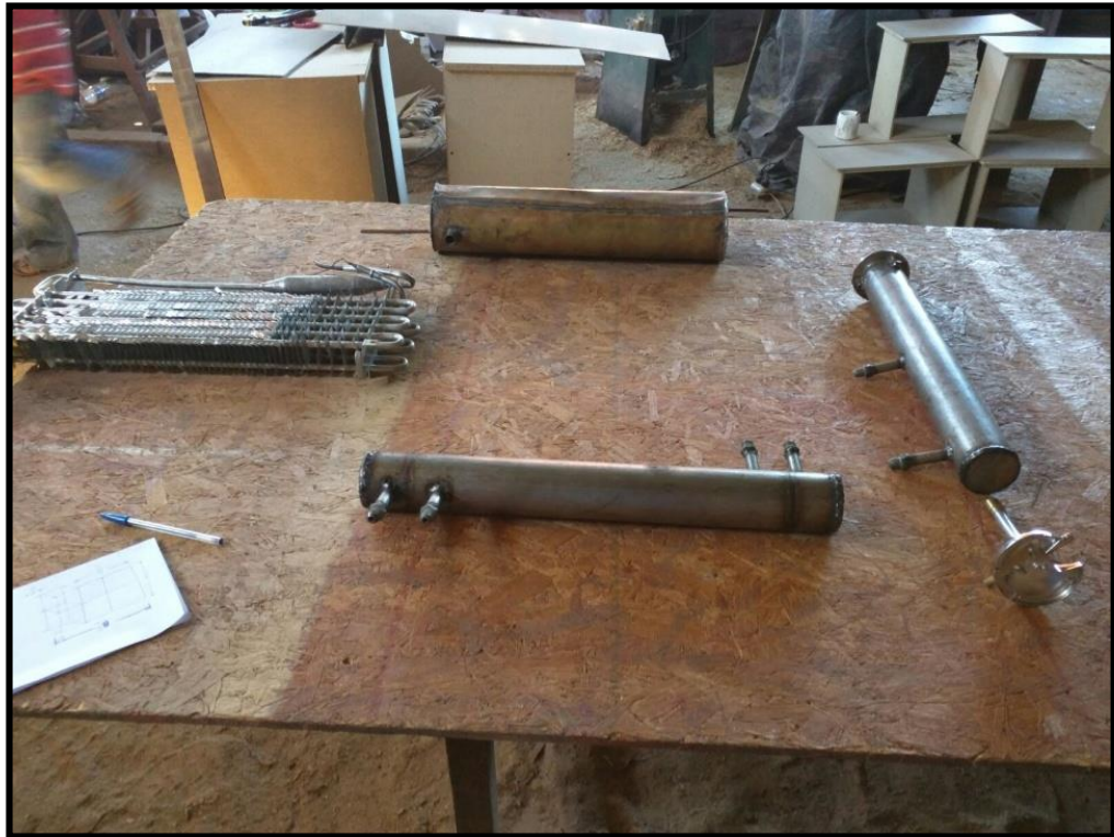
FIGURA 4.1.2.5.1 Acople del Sistema de Refrigeración
