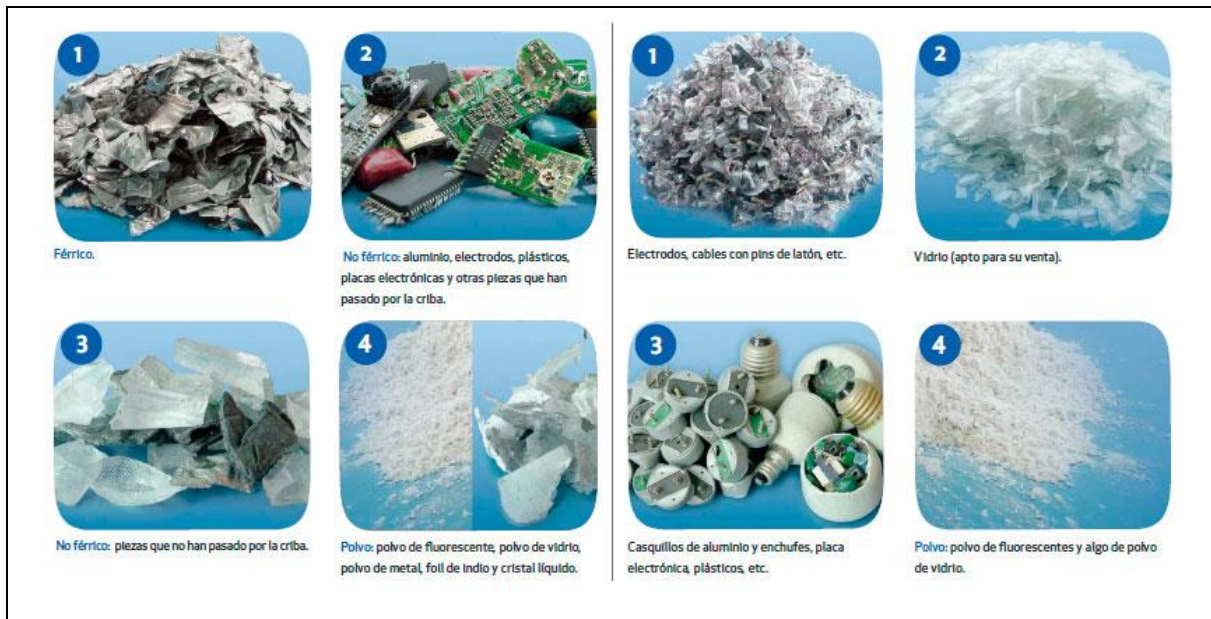
Figura 5.12 Componentes de lámparas fluorescentes post-tratamiento Fuente: www.recyclingequipos.com
