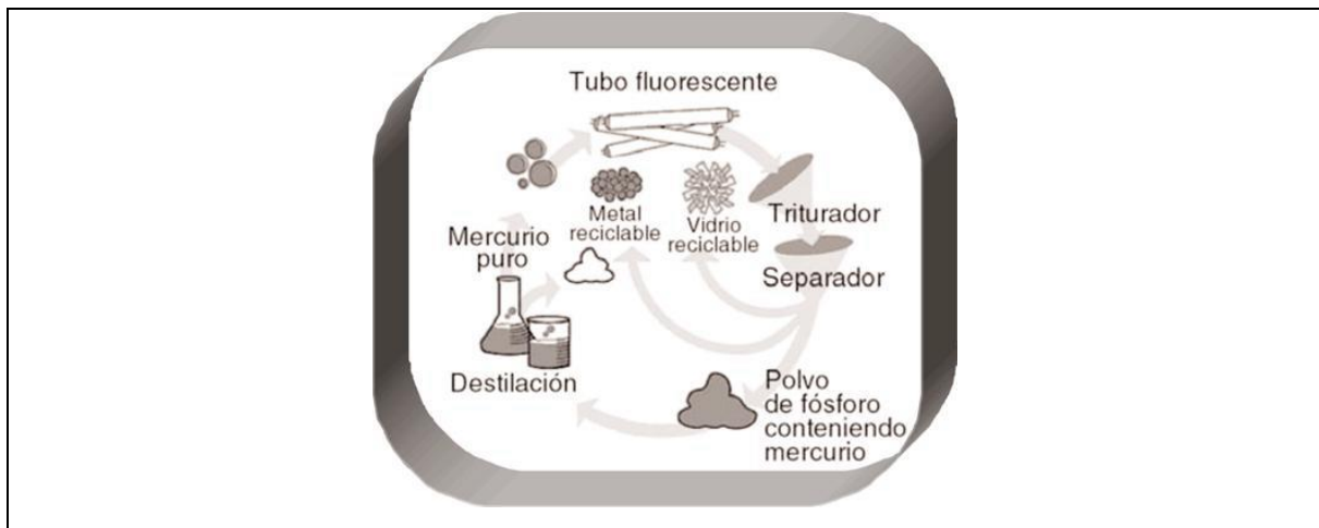
Figura 5.11 Componentes recuperados en el reciclaje de las lámparas fluorescentes Fuente: www.megaluz.com
