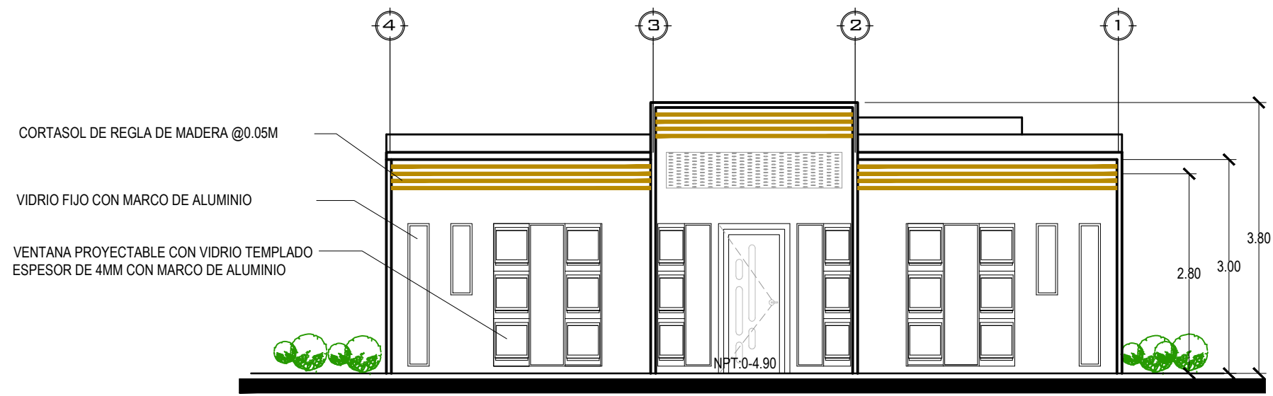
ELEVACIÓN NORTE DE CABAÑA DE HUESPEDES ESC: 1:75
