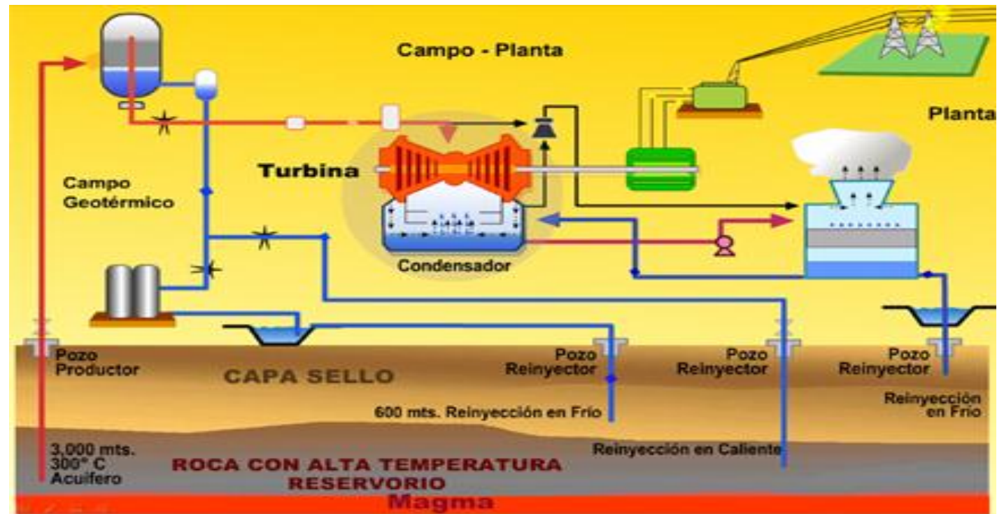
Imagen 11: proceso de producción de energía geotérmica
