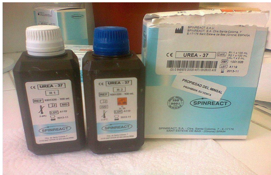
FIGURA 10. Reactivo de Urea para determinar Nitrógeno Ureico. (Técnica Spinreact)
