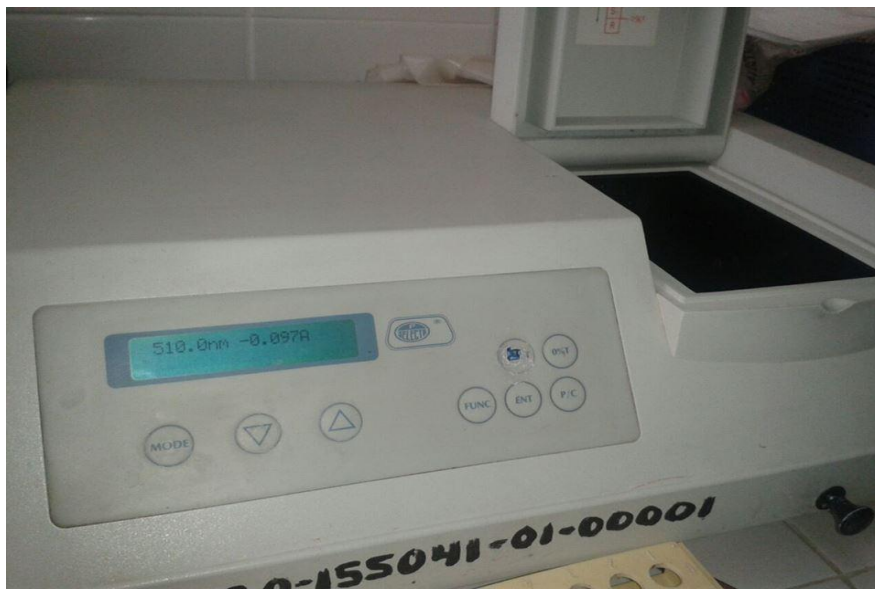
FIGURA 8. Espectrofotómetro utilizado en la lectura de muestras con las determinaciones de Creatinina, Nitrógeno Ureico y Ácido Úrico.
