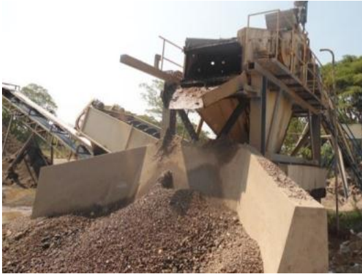
FIGURA No 4.12: Proceso de cribado y evacuación del material de sobre tamaño.
