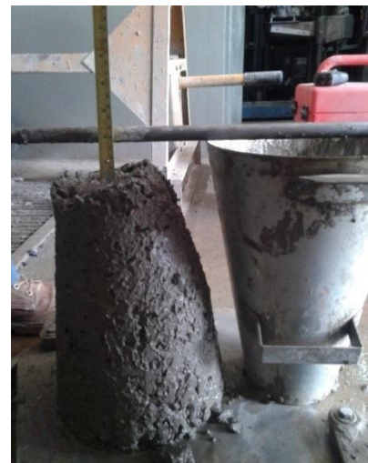
FIGURA No 4.18: Ensayo de Revenimiento
