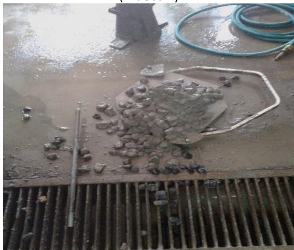
FIGURA No 4.40: Revenimiento en mezcla no cohesiva luego de adicionarle 1.5 litros de agua (Prueba 1).
