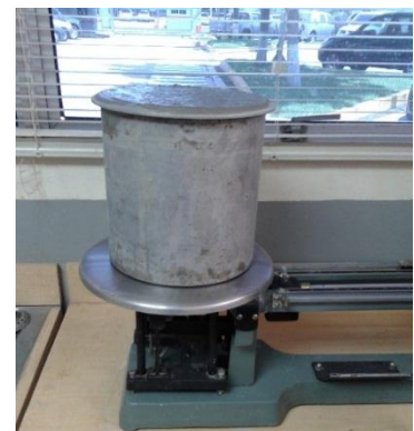
FIGURA No 4.20: Ensayo de Peso Volumétrico
