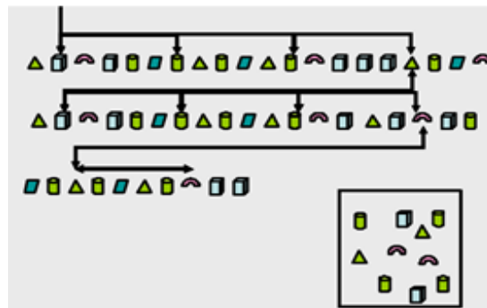
Ilustración 42 Representación gráfica del muestreo aleatorio sistemático
